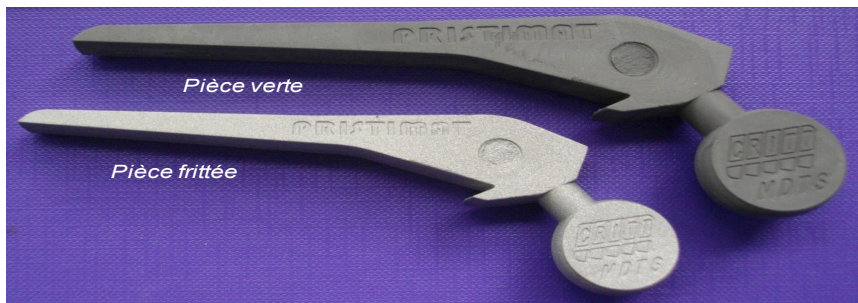
Photo avant et après frittage – Mise en évidence du retrait
