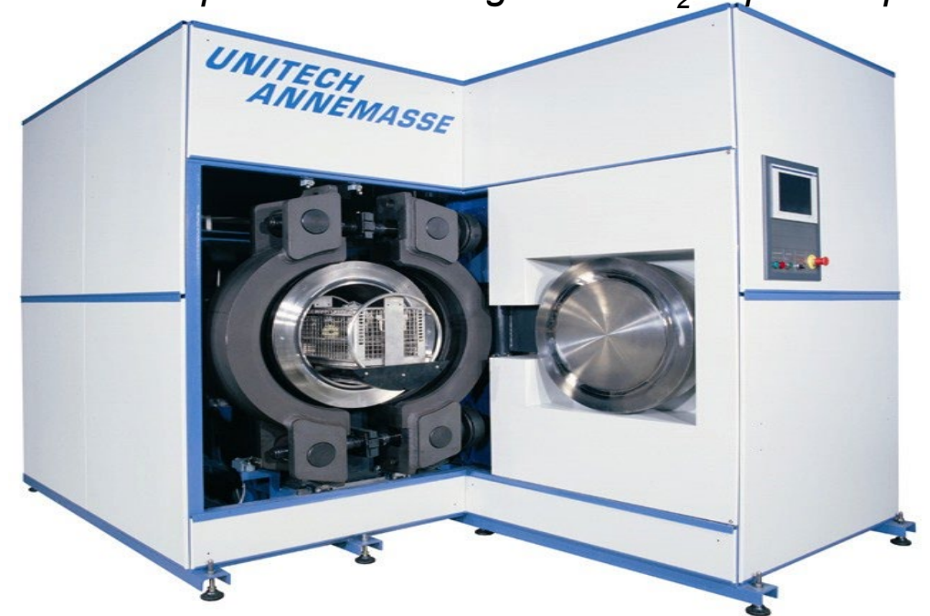
Installation pour le délantage au CO 2 supercritique
